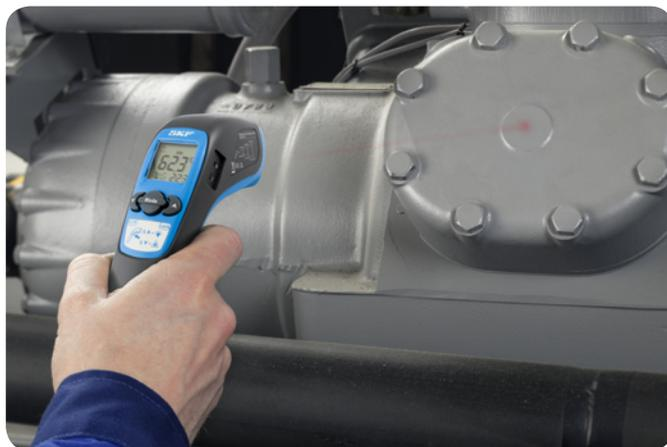
Cuando no está seleccionada la opción de medición por contacto, el termómetro percibe la energía térmica que irradian los objetos con un detector infrarrojo. Cuando se apunta a un objeto, el detector de infrarrojos recoge la energía, produciendo una señal que el microprocesador traduce en una lectura que aparece en la pantalla retroiluminada.
